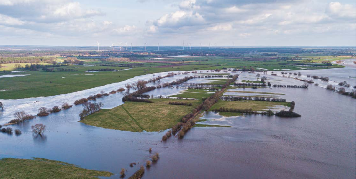
Im Februar 2020 überströmt die Aller die Ufer im Naturschutzgebiet „Allerschleifen“ südlich von Hülsen. Die Aue bietet Retentionsflächen für das Hochwasser. Durch die Wiederherstellung ehemaliger Hochflutrinnen und die Entwicklung des Gleitufers sollen im Rahmen des „Allervielfalt Verden-Projekts“ Fluss und Aue zukünftig besser vernetzt und das Wasser länger in der Fläche gehalten werden.
