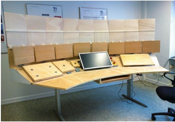
Holzmodell auf Grundlage des Ergonomiegutachtens (erstellt durch den Bauhof des WSA Mosel-Saar-Lahn)
